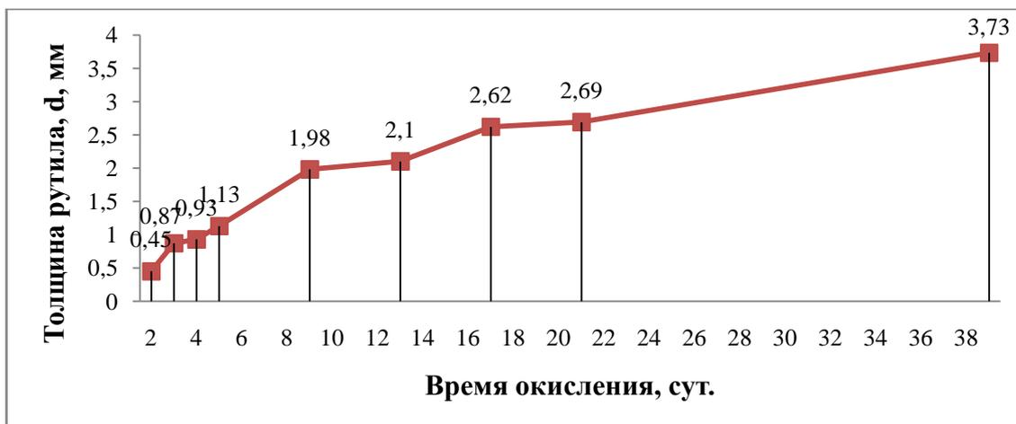
Рисунок 49 – Изменение толщины наросшего рутила на титановой преформе 30×20 мм за время её окисления в печи при 875 °С.
