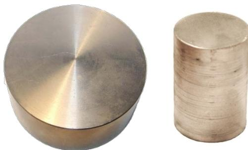
*Рисунок 12 – Вид дискообразных трехмерных титановых преформ.*
