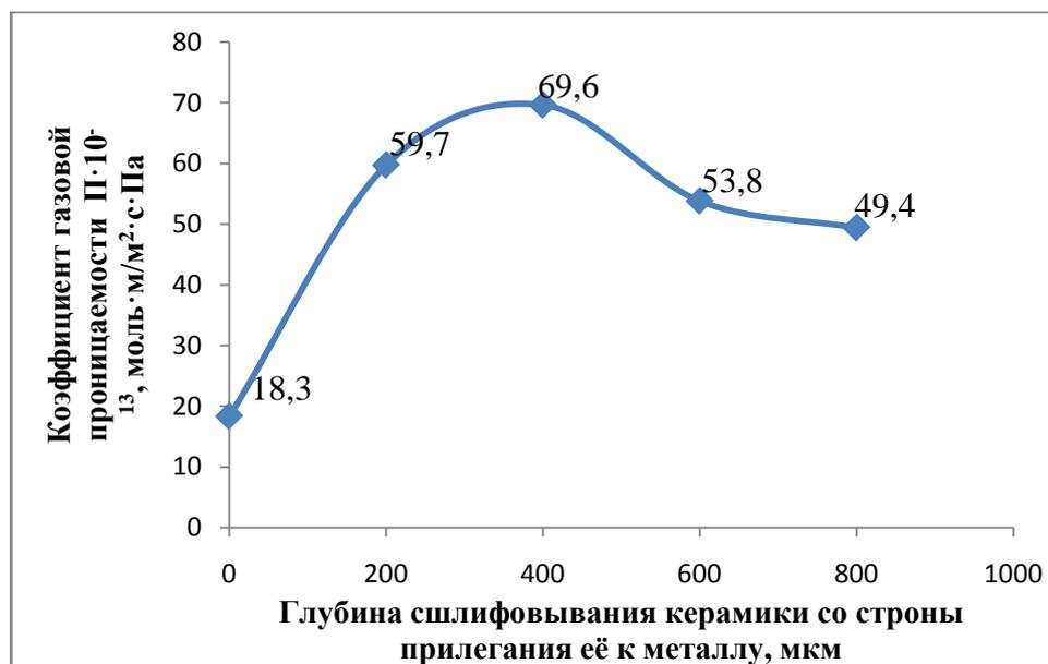
Рисунок 51 – Изменение газовой проницаемости образца рутила (синтез 7 суток, 875 °С, толщина  $d_{исх}=1618$  мкм), который подвергался поэтапной шлифовке по ~200 мкм вглубь образца со стороны прилегания керамики к металлу.
