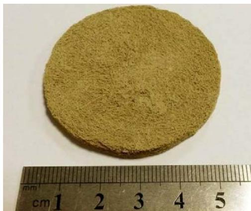
*Рисунок 69 – Оптическая фотография рутильного войлока.*
